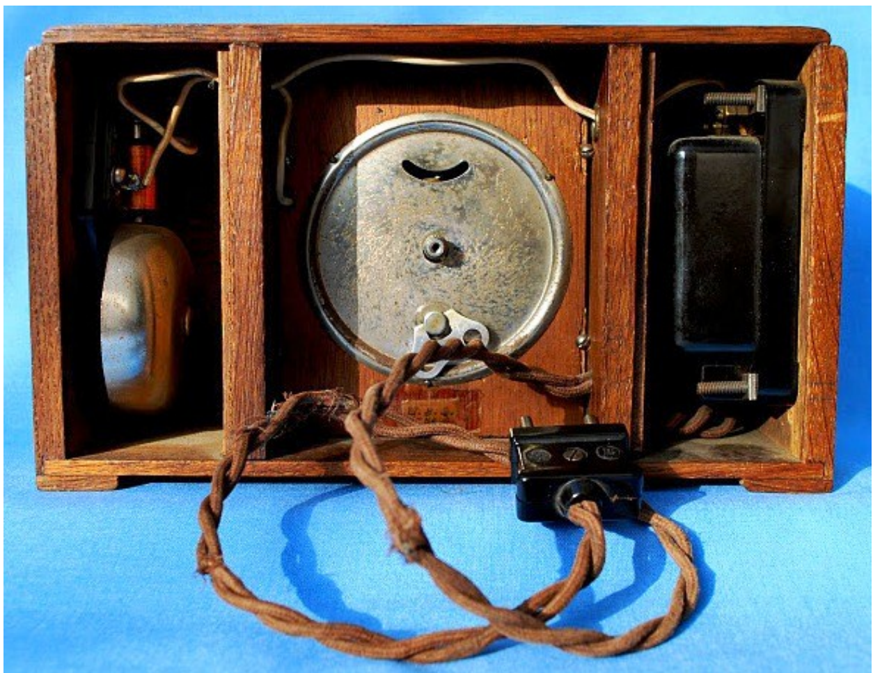
Het binnenwerk van bovengenoemde klok. Links de gong, rechts de transformator.
